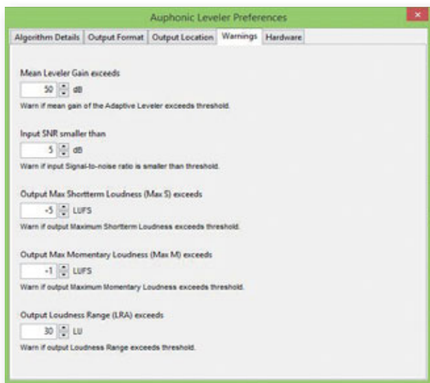
Für fünf Werte (Mean Leveler Gain, Input SNR, Output Max S, Output Max M und die LRA) lassen sich Thresholds definieren; werden diese bei der Bearbeitung überschritten, erscheint ein Warnhinweis
