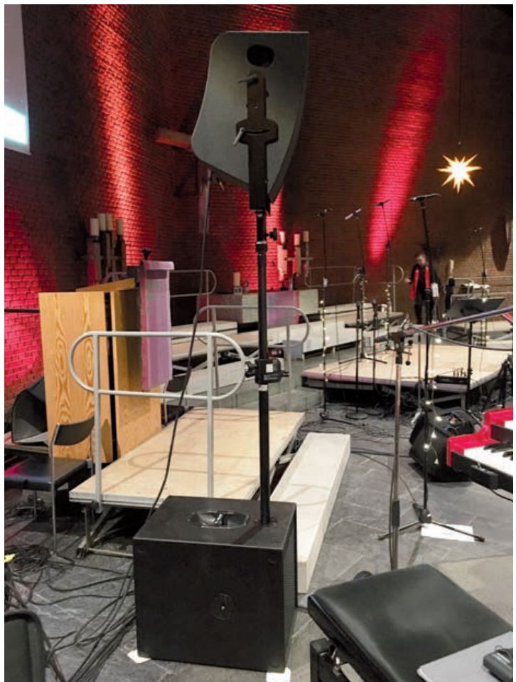
Beim „Banana Wave“ Array handelt es sich um ein transportables 2-Weg-Array mit festem Curving – es kann beispielsweise mit den PL Audio „Gorilla DSP-4000“ Bässen (hier die 15“-Version) kombiniert und von deren Endstufen angetrieben werden
