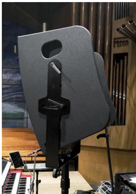
Seitlich sind Griffmulden zum Tragen eingelassen – außerdem finden sich Gewinde für das Anbringen eines Flugbügels oder der Stativ-Gabel
