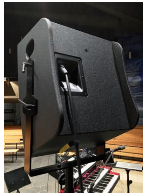
Da es sich um ein passives System handelt, zieren die Rückseite lediglich zwei vierpolige Speakon-Buchsen – die Seitenteile sind über die Rückseite hinaus verlängert und ermöglichen Transport und Lagerung der Boxen auf der Rückseite
