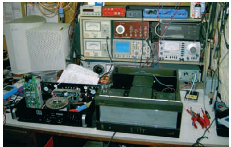
Bild 6: Die Technik der PA-400 kurz vor der Transplantation in die HiFi-Endstufe
